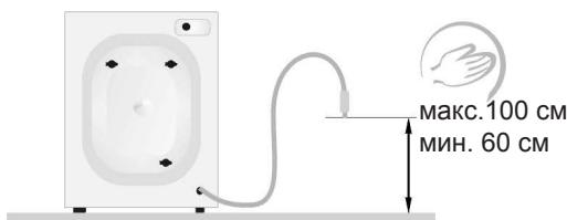
Сливной шланг находится сзади стиральной машины. Закрепите сливной шланг таким образом, чтобы он не перемещался во время работы стиральной машины (используйте для этого колено, как показано ниже). Не опускайте конец сливного шланга слишком глубоко в водосток!
